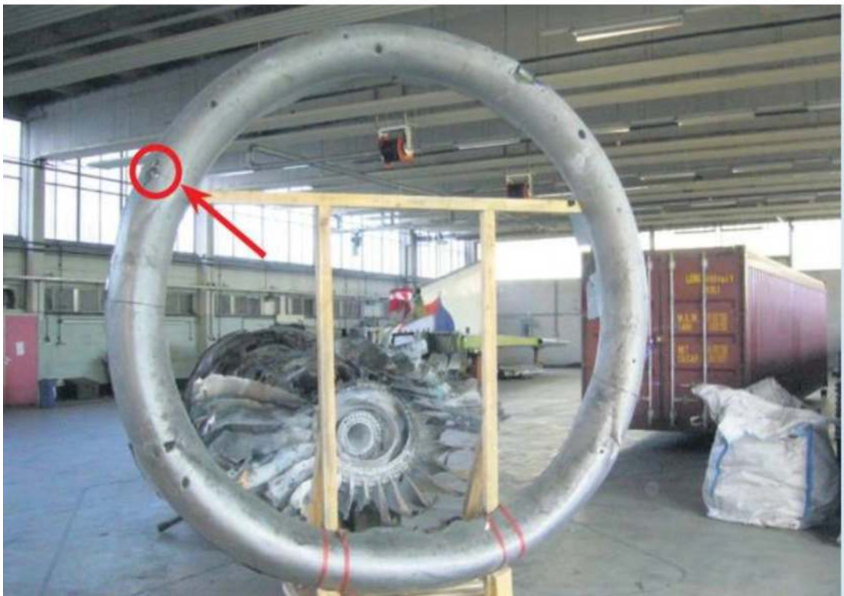
左エンジン流入リングの損傷分析
