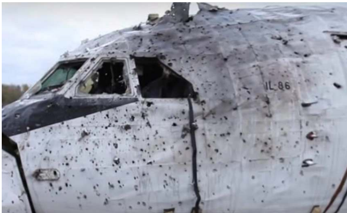
アルマズ・アンンティ実験結果：コクピットに軽微凹み。中央窓破碎。蝶型・方形衝撃痕の均一パターン。30mm穴の欠如。
